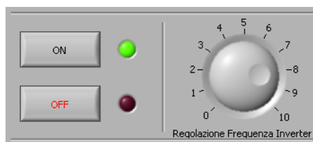
Figura 6.6: Tasti di avvio/arresto impianto e manopola regolazione frequenza di alimentazione della pompa
