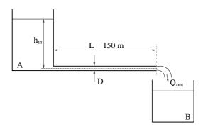
1. La porta volumetrica minima da trasferire per garantire il trasporto è  $Q_{tr} = V_{tr}/t = 4.17 \cdot 10^{-4} \ m^3/s$ . Applicando Bernoulli tra il pelo libero del serbatoio A (sez. 1) ed il punto di scarico della tubazione (sez. 2), si trova:
